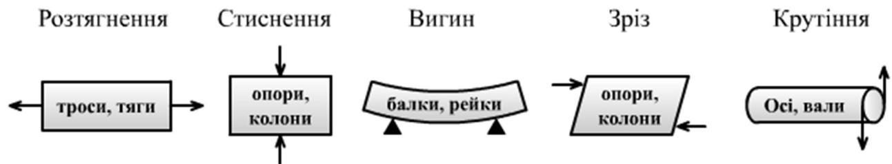
Міцність — це здатність матеріалу чинити опір руйнуванню під дією навантажень. Міцність оцінюється максимальним навантаженням, що витримує матеріал без руйнування, навантаженням, при якому відбувається пластична деформація.
