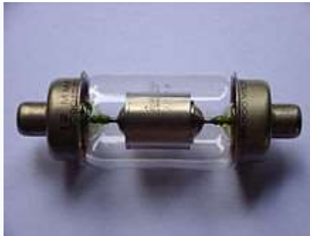
Вакуумний конденсатор сталої ємності (12 пФ, 20 кВ)
