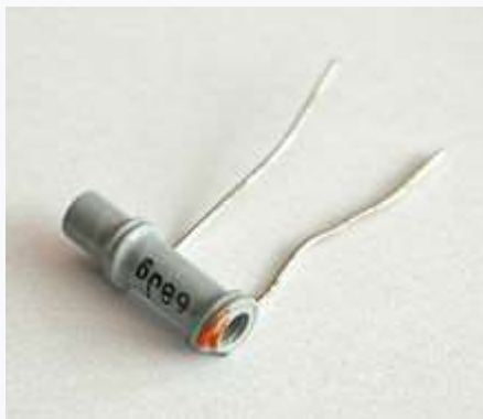
Вакуумний конденсатор сталої ємності (12 пФ, 20 кВ)
