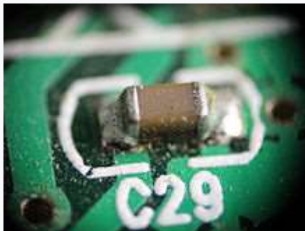
Конденсатор поверхневого монтажу (SMD) на платі, макрофотографія
